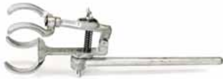
LA-120 Держатель четырехпальцевый (с узлом крепления)
