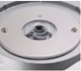
Надежно герметизированный суппорт чашки весов DL-WP
