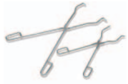
Различные щипцы для загрузки и выгрузки деталей
