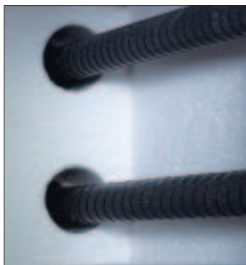
Камера печи из высококачественного волокнистого материала с нагревательными стержнями из SiC в боковых стенках печи
