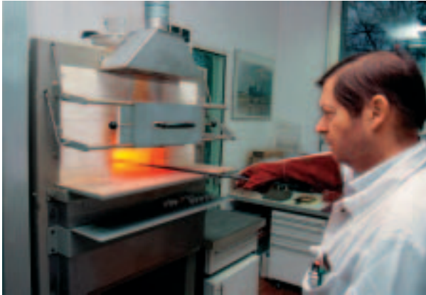
N 110/HS1 с поднимаемой дверью для опытов по плавке золота
