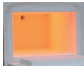
керамический муфель со всесторонним обогревом
